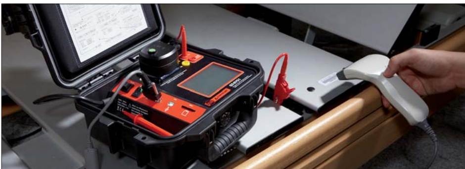
Isolationswiderstandsmessung bei Geräten der Schutzklasse I
