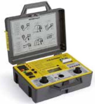
0100-Multitester (erster Multifunktions- Installationstester)
